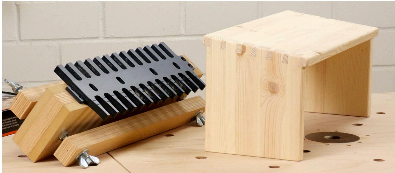
Einfach, schnell und absolut präzise! Mit der Aluschablone der amerikanischen Firma Peachtree gelangen euch die schrägen Eckverbindungen für ein solches Meditationsbänkchen auf Anhieb und sind auch noch super stabil.
