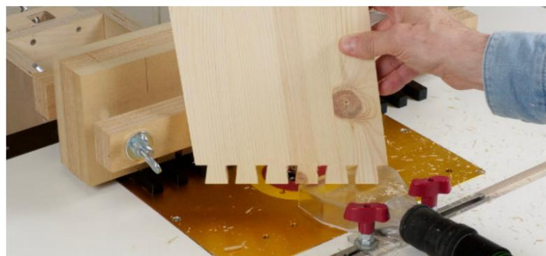
Da die Schwalben immer exakt rechtwinklig zur Schrägkante verlaufen, ist diese maschinelle Zinkung zwar fachlich nicht hundertprozentig korrekt, ...
