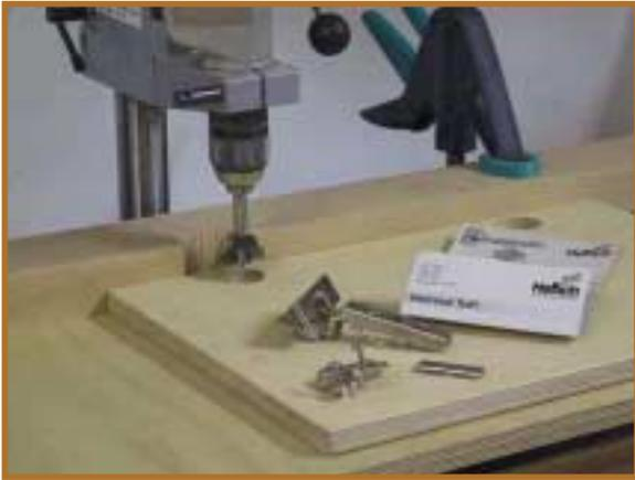
**21** Dann werden einfach auf einem Bohrständler mit einem 35 mm Forstnerbohrer, entsprechend der Markierungen zwei Löcher gebohrt. Bei diesen Topfscharnieren werden keine Befestigungsschrauben mehr benötigt. Sie klemmen sich durch Herunterdrücken einer Lasche im Bohrloch fest.
