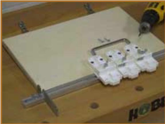
**22** Und wieder ein Anwendungsfall für die Exakta Bohrlehre, denn auch Griffe und Knöpfe sind im Nu mit Hilfe der Schablone gebohrt. Fast alle modernen Griffe sind heute im Raster 32 mm gefertigt. Doch Vorsicht: bei all den Bohrungen verliert man schnell den Überblick und damit Sie nicht die falsche Bohrung nehmen, sollten Sie alle nicht benötigten mit Klebeband zukleben.
