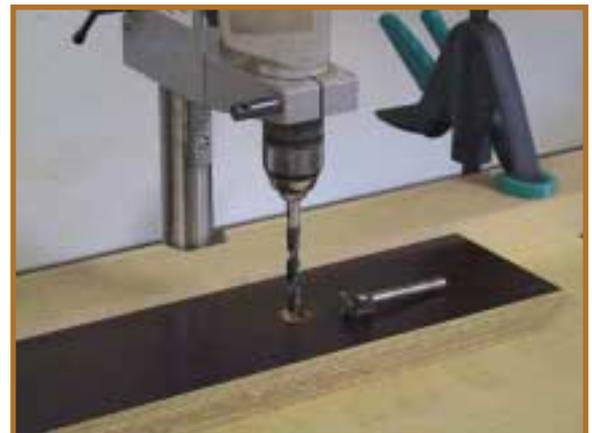
**12** Eine 5 mm dicke Plexiglasscheibe mit entsprechender Bohrung für den Absaug Schlauch, sorgt für die nötige Sicht beim Fräsen. Mit vier Schrauben wird das Ganze von Hand auf den mittleren Winkelstützen befestigt. Zur Not können Sie auch eine 10 mm Sperrholzplatte verwenden - mit freier Sicht ist dann allerdings Schluß!
