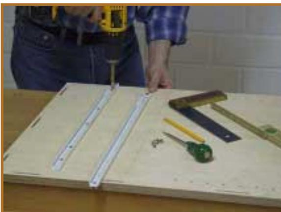
16 Auch die Auszugschienen der Rollschubführungen und die Montageplatten der Topfscharniere sollten Sie schon jetzt vor dem Zusammenbau montieren. Bei einem Schrankzwischenraum von 265 mm gibt es später Probleme mit dem Akkuschauber.
