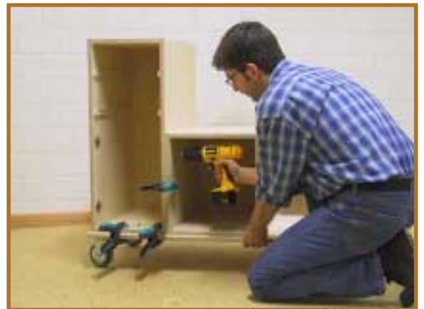
**20** Mit der Bohrlehre Exakta, die auch für die Lochreihen benutzt wurde, können Sie auch sehr leicht die Bohrungen für die 35 mm Topfscharniere ankörnen. Hierzu befinden sich entsprechende Bohrungen auf den Bohrkörpern. In diese Bohrungen kann ein Zentrierstift zum Ankörnen eingesteckt werden und überträgt so den nötigen Bohrpunkt auf das Holz - eine feine Sache!!!
