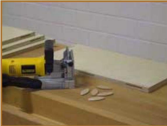
14 Für die Schlitzte in den Stirnseiten der Platten benutzen Sie einfach die ebene Fläche der Hobelbank. Sie sollten bei einer Schranktiefe von 535 mm in jedem Fall drei Flachdübel einfräsen.
