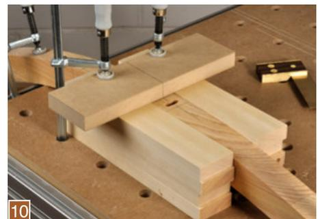
10 ... festgespannt. Dann wird die Maschine hochkant gegen diese Leiste gelegt, genau auf die Mittenmarkierung ausgerichtet und der 10 mm Dominoschlitz gefräst.
