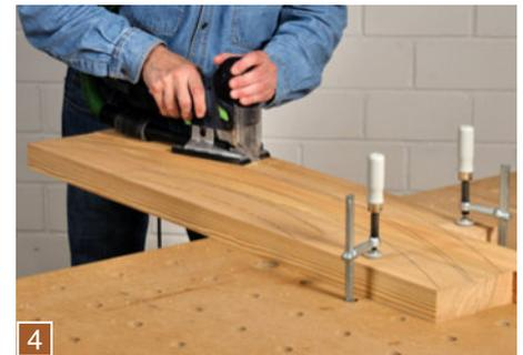
**4** Anschließend sägen Sie mit einem hochwertigen HSS Sägeblatt die einzelnen Bauteile heraus. Bleiben Sie wenn möglich nur maximal 1 mm vom Strich entfernt.
