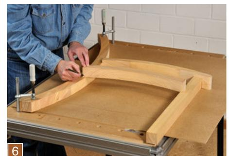
**6** Die fertig geschliffenen Bauteile legen Sie anschließend auf den 1:1 Aufriss und markieren sich mit einem Bleistift die Schnittpunkte und somit die genaue Länge der Teile.
