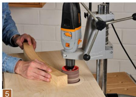
**5** Entfernen Sie die Sägeblattspuren an den Holzkannten mit einer großen Schleifhülse. Diese Hülsen können in jeder Bohrmaschine oder Ständerbohrmaschine betrieben werden.
