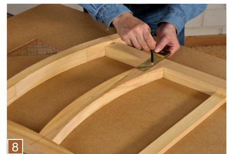
**8** Sind alle Bauteile exakt zugeschnitten legen Sie alle auf den Aufriss und markieren sich mit einem Winkel die Mittenpositionen der einzelnen Dominos. Anhand dieser Striche wird später die Dominofräse genau ausgerichtet.
