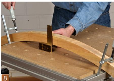
8 Für den Gegenschlitz legen Sie die Rückenlehne auf den Tisch und richten sie mit einem Winkel genau auf die zuvor gemachte Markierungslinie für den Dominoschlitz aus.
