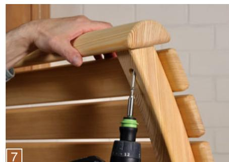
7 Die Abdeckung wird einfach mit je einer entsprechend langen Schraube befestigt. Auch hier unbedingt vorbohren und diesmal großzügig versenken.
