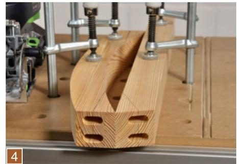
4 ... Skalafenster an. Nach dem ersten Schlitz werden die Werkstücke immer gedreht und auch von der anderen Seite bearbeitet, so dass ein Doppelschlitz (Doppelzapfen) entsteht.
