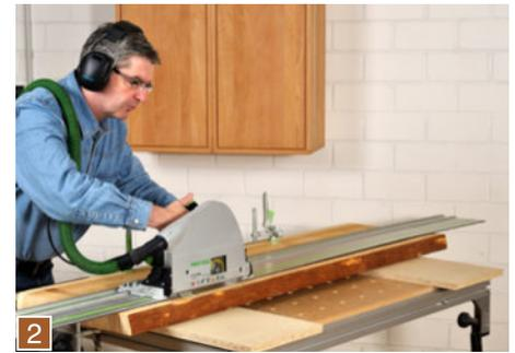
**2** Nachdem Sie die Holzbohlen mit etwa 5 cm Maßzugabe abgelängt haben, trennen Sie die Waldkante (Rinde) mit der Tauchsäge und einer langen Führungsschiene ab.
