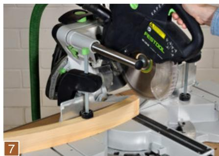
**7** Auf der Kapex können Sie die Markierung genau unter dem Doppellaser positionieren und das Bauteil so präzise ablängen. Ansonsten das ruhende Sägeblatt bis zur Markierung absenken, Werkstück ausrichten, fixieren und erst dann mit laufender Säge ablängen.
