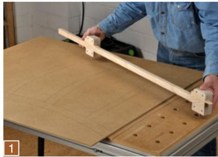
**1** Fertigen Sie sich zuerst eine genaue 1:1 Zeichnung der Seitenansicht auf einer ausreichend großen Hartfaserplatte an. Das erleichtert den Bau ungemein.
