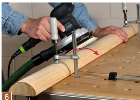
6 Die letzten Unebenheiten werden dann noch mit dem Exzenterschleifer herausgeschliffen. Dabei die Kontur mit dem Exzenterschleifer immer in Pfeilrichtung rund abfahren.
