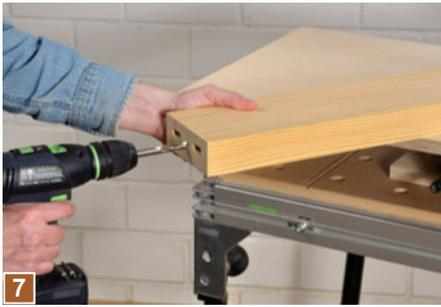
Da das 10 mm Loch in den Stirnden der Balken mindestens 70 - 80 mm tief sein muss, wird es anschließend noch etwas nachgebohrt.
