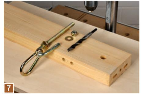
Für die Schaukelhaken wird zuerst ein 12 mm großes Durchgangsloch gebohrt und im entsprechenden Abstand daneben noch ein Sackloch für das Hakenende. So kann sich die Schlaufe nicht selbstständig aus dem Haken heraus lösen.
