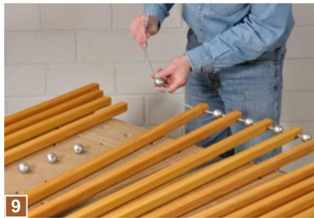
Die Hollywoodschaukel ist im Prinzip nur aus Holzleisten und Holzkugeln aufgebaut, die immer im Wechsel auf ein 5 mm dickes, kunststoffummanteltes Stahlseil aufgesteckt werden. Vor der Montage aber alle Holzteile bereits mit einer Schutzlasur versehen.
