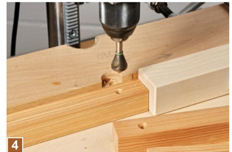
4 Anschließend werden alle Löcher von beiden Seiten etwa 3-4 mm angesengt, damit das Stahlseil später von der scharfen Lochkante nicht zu sehr beansprucht wird.
