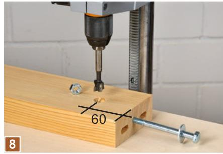
60 mm vom Balkenende entfernt wird ein 20 mm großes und ca. 32 mm tiefes Sackloch zur Aufnahme der M10er Mutter gebohrt.
