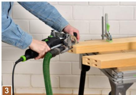
**3** ... erst in die Längs- und anschließend in die Stirnkanten die Dominos eingefräst. Wichtig: Die Mitte der Domino-Positionen genau anzeichnen und danach die Maschine ausrichten.
