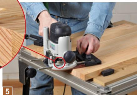
5 Spannen Sie mehrere Holzleisten hintereinander auf den Werkstisch. So erhalten Sie mehr Auflagefläche, um die Stirnkanten mit einem Abrundfräser (Ø 5 - 6 mm) zu bearbeiten. So gelingt das Abrunden der schmalen Leisten ...
