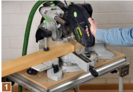
**1** Zuerst werden die entsprechenden Gehrungen an Stand-, Stütz- und Querbalken mit einer Kappsäge angesägt. Auch die Längs- und Trägerbalken werden damit abgelängt.
