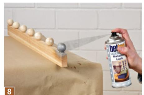
8 Die Holzleiste lassen sich am besten mit einer Sprühdose lackieren. Schlagen Sie dazu kleine Nägel in die Kante einer Holzleiste und stecken Sie anschließend die Kugeln auf.
