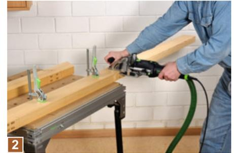
**2** Nachdem die Balkenpositionen laut Bauplan aufgezeichnet wurden, werden die Balken mit je vier 10 x 50 mm Dominos aus Sipo-Holz verbunden. Mit der Dominofräse werden dazu ...
