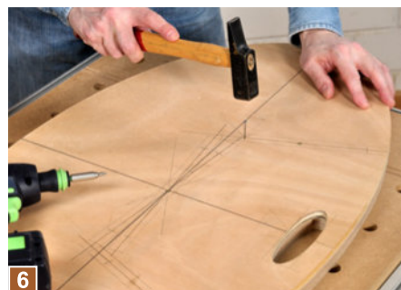
6 ... Schablonenkante anliegen. Bevor Sie dann die Schablone wieder los-schrauben, werden zuerst noch die Markierungspunkte für Sitz- und Rückenlehne mit einem Nagel ange-körnt.
