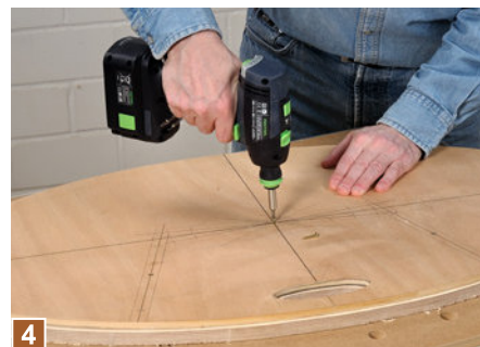
4 ... um den Rest mit der Oberfräse und der Schablone genau auszufräsen. Befestigen Sie anschließend die Schablone mit drei Schrauben auf dem Seitenteil.
