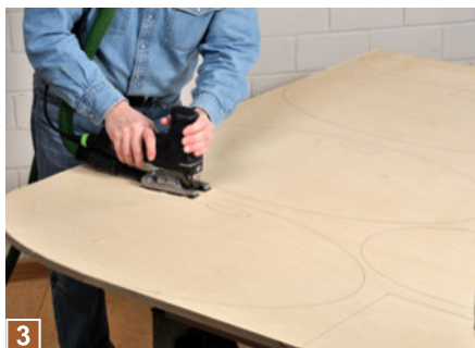
3 Dann werden alle Holzteile entsprechend des Zuschnittplans aufgezeichnet und mit einer Stichsäge samt Kurvensägeblatt ausgesägt. Bleiben Sie dabei maximal 3 mm vom Strich weg ...
