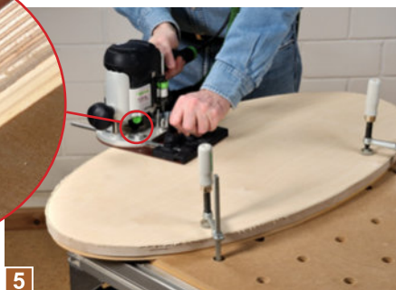
5 Den Überstand der Multiplexplatte können Sie jetzt präzise mit einem Bündigfräser (kl. Foto) passend bis zur Schablonekante abräsen. Das Kugellager muss dabei genau an der ...
