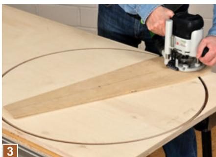
**3** Fräsen Sie dann in drei Arbeitsgängen von je 6 mm Frästiefe mit einem 10 mm Nutfräser eine Kreisrunde 18 mm tiefe Nut in die 21 mm dicke Multiplexplatte.
