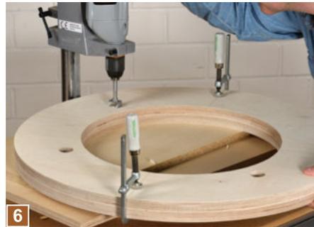
**6** Um die Löcher für die Rundstäbe zu bohren, spannen Sie die Räder aufeinander und durchbohren beide gleichzeitig. Dadurch sind alle Löcher auch absolut deckungsgleich.
