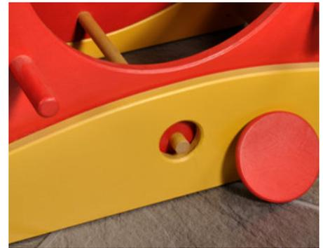
Ein 20 mm Rundstab aus Buche dient als Überschlagsicherung. Die maximal mögliche Schaukelbewegung wird durch die Größe des Lochs in der Seitenblende festgelegt. Eine runde Abdeckung verhindert schließlich, dass neugierige Kinderfinger eingeklemmt werden.
