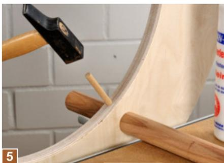
**5** Zum Schluss den 8er Dübelstab mit etwas Leim in das Bohrloch einschlagen. Dabei sollte der Dübel auf der Rückseite des Rundstabs noch etwa 20 mm tief ins Rad reichen.
