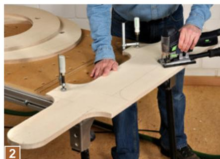
**2** Anschließend sägen Sie diese Umriss mit einer Stichsäge und einem Kurvensägeblatt aus, wodurch sich dann auch die genaue Sitzlänge ergibt.
