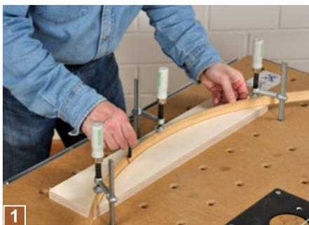
**1** Markieren Sie sich die Bogenmitte und die Außenkanten und spannen Sie dort eine dünne Leiste mit drei Zwingen fest. Anschließend den Bogen mit einem Bleistift abfahren.
