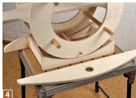
**4** ... eingesteckten Sicherungsstab in das Loch der Seitenblende und auf die Kufen gestellt und erst dann die zweite Seitenblende an der anderen Kufe befestigt.
