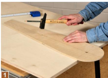
**1** Schlagen Sie in die 9 mm dicke Multiplexplatte, die als Zirkel dient, einfach einen Nagel als Dreh- bzw. Kreismittelpunkt ein. Der Abstand vom Nagel bis zum Fräser beträgt 350 mm.
