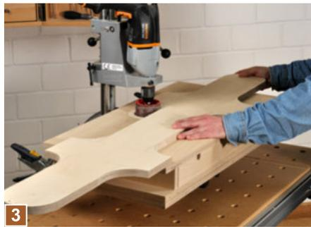
**3** Den Sägeschnitt an den Sitzkanten glätten Sie am besten mit einer Schleifhülse, die Sie einfach in einer Bohrmaschine im Bohrständer betreiben.
