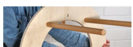
**4** ... das ungefähr mittig durch das 30er Loch verläuft. Dann den Rundstab einstecken und das Loch noch durch den Stab hindurch verlängern.
