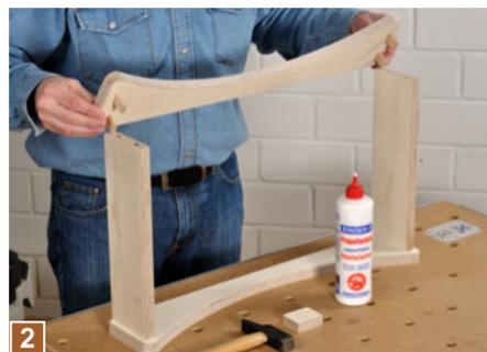
**2** Achten Sie darauf, dass beide Kufen genau deckungsgleich sind und keine Dellen aufweisen. Danach die Kufen mit Dominos an den Querstreben verbinden und verleimen.
