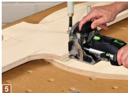
**5** Dann legen Sie die Maschine flach auf das Rad und fräsen auch in die Stirnkante des Sitzbretts je zwei Dominos ein, diesmal aber mit einer Frästiefe von 25 mm!
