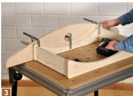
**3** Als nächstes wird zuerst nur eine Seitenblende mit vier Schrauben an einer Kufe festgeschraubt. Dann wird das komplette Schaukelrad mit dem fertig ...
