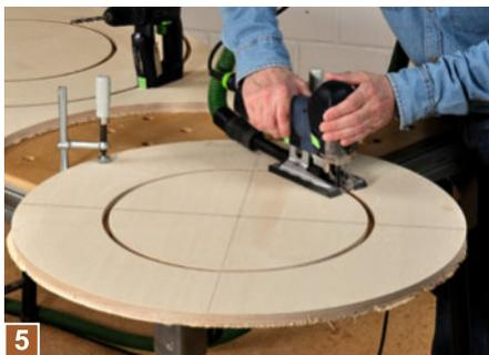
**5** Sägen Sie die Räder dann grob mit einer Stichsäge aus der Platte heraus. Danach den Restüberstand einfach mit einem Bündigfräser bis zur Kreiskante abräsen.
