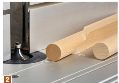
**2** ... und eine mit 20 mm Querschnitt, sowie einen Abrundfräser mit 15 und einen mit 10 mm Radius. Dann einfach nacheinander alle vier Kanten am Anschlag vorbei schieben.
