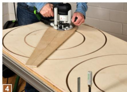
**4** Zuerst auch den zweiten Außenkreis fräsen, bevor Sie einen weiteren Nagel im Abstand von 190 mm zum Fräser in die Zirkelplatte einschlagen (190 + 10er Fräser = 200 mm Radius).
