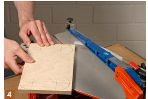
4 Sägen Sie die drei Kanten möglichst präzise aus. Feilen und schleifen Sie Unebenheiten sehr sorgfältig heraus, damit der Rollladen später eine perfekte und gleichmäßige Führung hat.
