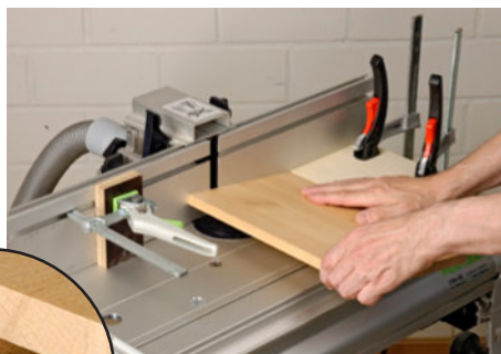
... fräsen werden am Anschlag Stophölzer befestigt, wobei die hintere Platte gleichzeitig als Rückschlagsicherung dient.
