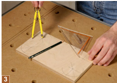
3 Bis der Leim abgebonden hat, können Sie die Zeit nutzen, um aus einer 9 - 12 mm dicken Multiplexplatte eine Schablone für die Rollladennut herzustellen (s. Zeichnung S. 8).
