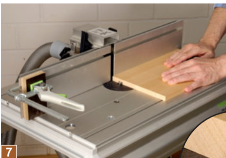
7 Die Nuten für den Boden und das Rückteil werden mit einem 14 mm Nutfräser auf dem Frästisch hergestellt. Damit Sie nicht zu weit ...
