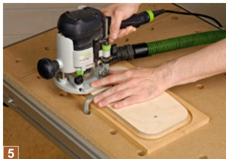
5 Befestigen Sie die Schablone genau mittig mit zwei Schrauben auf den Seitenteilen und fahren Sie die Kontur gegen den Uhrzeigersinn mit einer 17er Kopierhülse und einem 8 mm Nutfräser ab.
