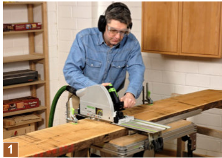
1 Zuerst werden die 52er Kirschbaumbohlen mit der Handkreissäge abgelängt (mit mindestens 50 mm Maßzugabe), anschließend besäumt und in 19 mm dicke Streifen gesägt.
