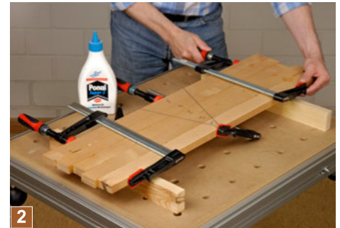
2 Wenn Sie eine Hobelmaschine ab ca. 300 mm Arbeitsbreite besitzen, können Sie zuerst nur die Kanten der Streifen „fügen“, um sie danach zu einer größeren Platte zu verleimen.
