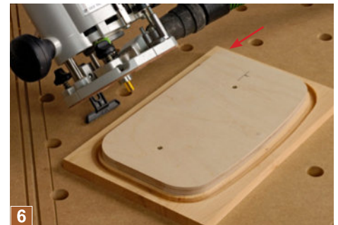
6 Achten Sie darauf, dass die Nut an der nicht gerundeten Ecke (Pfeil) stoppt und nicht durchgefräst wird. Die genauen Maße dazu finden Sie wieder in der Zeichnung am Ende des Artikels.
