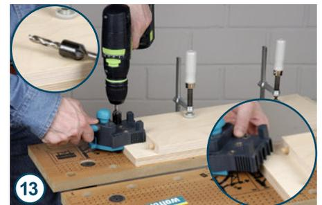
Boden so auf die passende Seitenwand zwingen, dass der Anschlag an der Seitenwand anliegt. Dübelhilfe mit der Führungsnut über den eingeleimten Dübel schieben und diesmal mit einem ...
