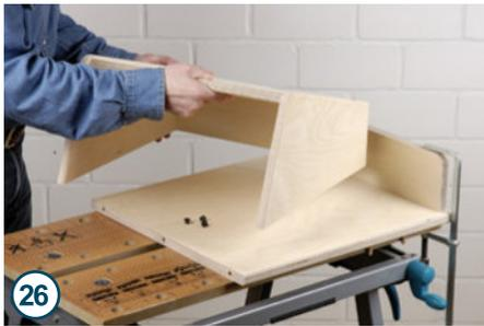
Stecken Sie anschließend den Trichter einmal ohne Leim zusammen und übertragen Sie die Dübellöcher wieder mit Dübelspitzen auf die Seitenwand.
