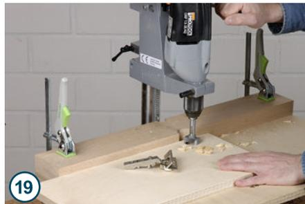
... Tür ausrichten und den Bohrpunkt markieren. Anschließend die Tür auf den Bohrständer legen und mit einem 35 mm Forstnerbohrer das Topfloch bohren.
