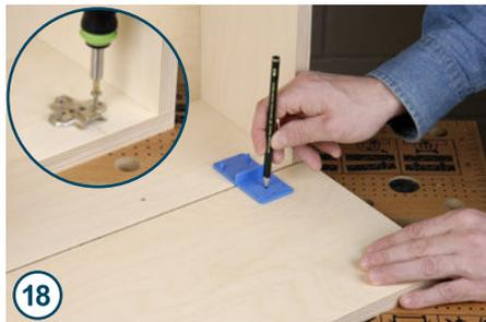
Die beiden Kunststoffstifte auf der Bohrlehre werden dann einfach in die gebohrten Löcher gesteckt und die Tür gegen die Bohrlehre geschoben. Die ...
