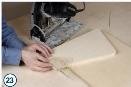
Um die Schräge der Bodenkante und der Trichterfront zu ermitteln, legen Sie einfach ein Geodreieck an die Trichterwand und lesen den Winkel ab. Es ist überhaupt kein Problem, wenn der ...
