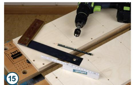
... nach Anriss benutzt. Auch die Positionen der Bodenträger für die Einlegeböden werden mit einem Winkel aufgezeichnet. Anschließend mit einem 5 mm Bohrer die Löcher bohren.
