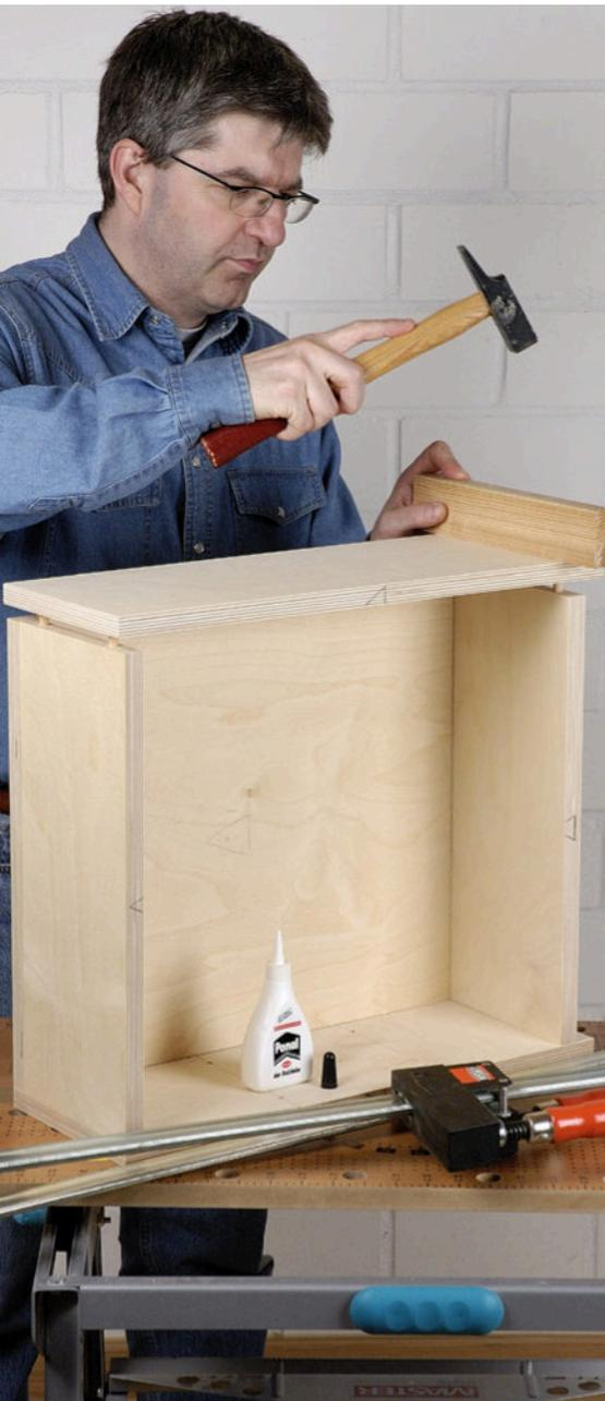
Bevor Sie den Schrank verleimen, sollten Sie zunächst einmal alle Teile ohne Leim auf Passgenauigkeit überprüfen. Erst wenn alles passt und genügend Zwingen vorhanden sind wird das Ganze verleimt.
