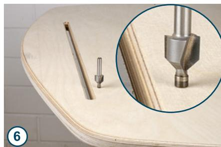
Die Kanten des Papierschlitzes kann man entweder mit Schleifpapier entschärfen oder mit einem Fasefräser mit Anlaufzapfen. Fräser mit Kugellager können im Schlitz nicht eingesetzt werden.
