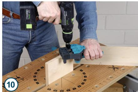
Bohrtiefe mit einem Tiefenstopp auf 28 - 30 mm begrenzen. Dübelhilfe auf die Brettkante legen und je zwei Löcher in die Holzkanten der Böden bohren.
