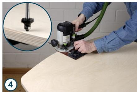
Alle scharfen Holzkanten sollten Sie mit einem Abrundfräser mit Kugellager (hier  $R = 6,35$ ) bearbeiten. Die Fräse wird dabei vom Kugellager, das an der Holz-kante anliegt, perfekt geführt.
