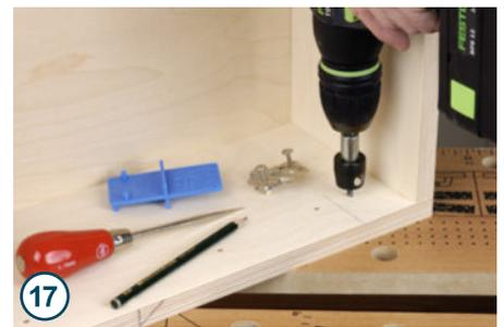
... auf die Seitenwand übertragen werden. Anschließend werden mit einem 5 mm Holzbohrer zwei Löcher für die Befestigungsschrauben gebohrt.
