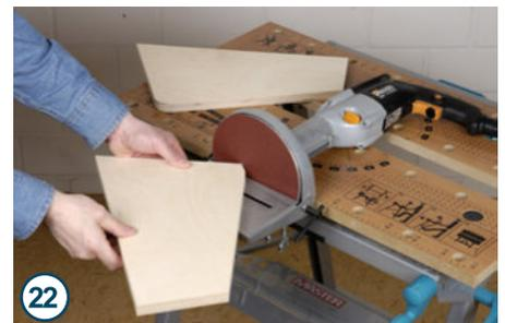
... Seitenwand an der gleichen Position liegt, wird ein Anschlagbrettchen mit einer Zwinne befestigt. Sind beide Schrägen gesägt, wird die Kante noch mit dem Tellerschleifer oder einer Feile gerundet.
