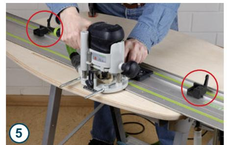
Der 51 cm lange Papierschlitz wird mit einem 8 mm Nutfräser und einer Führungsschiene eingefräst (max. 6 mm tief pro Fräsgang!). Zwei Anschläge sorgen dafür, dass man nicht zu weit fräst.
