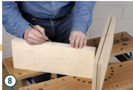
Damit die Schrankteile später nicht mehr vertauscht werden, sollten Sie die Seitenwände und Böden mit dem so genannten „Schreinerdreieck“ markieren.
