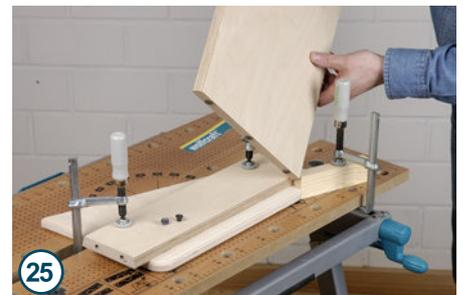
Die Stirnlöcher in Boden und Trichterfront werden wieder mit der Dübelhilfe gebohrt. Das Übertragen der Gegenlöcher übernehmen diesmal so genannte Dübelspitzen bzw. Dübelmarkierer.
