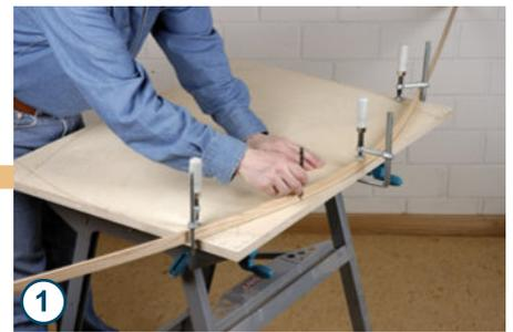
Die geschwungene Form der Tischkanten lässt sich am besten mit einer dünnen Holzleiste, die mit drei Zwingen gehalten wird, auf die Platte übertragen.
