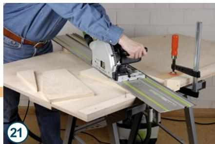
Zeichnen Sie sich die Schrägen genau auf die Trichterwände, legen Sie die Führungsschiene exakt auf die Bleistiftlinie und spannen Sie sie mit den Spezialzwingen fest. Damit die nächste ...
