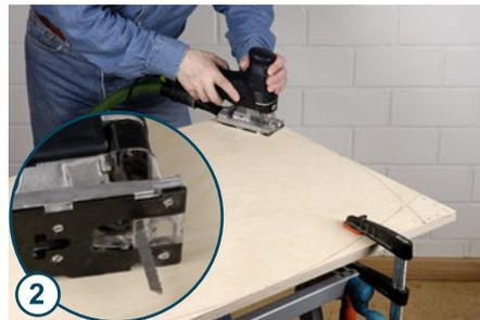
Danach ein fein gezahntes Stichsägeblatt (am besten aus HSS) und den Splitterschutz aus Kunststoff auf die Säge montieren und die Umriss aussägen.
