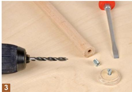
**3** Zum Wechseln der Papierrollen, wird an einem Ende des Rundstabs eine Eindrehmuffe mit M4 er Innengewinde eingebohrt. Später muss lediglich das Plättchen abgeschraubt werden.
