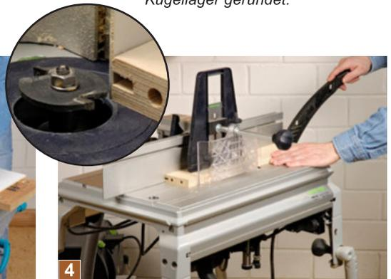
4 Die Tafelplatte steckt später in einer Nut der Rahmenhölzern. Sie wird einfach mit einem Scheibennutfräser auf einem Frästisch in die Rahmenkante gefräst.
