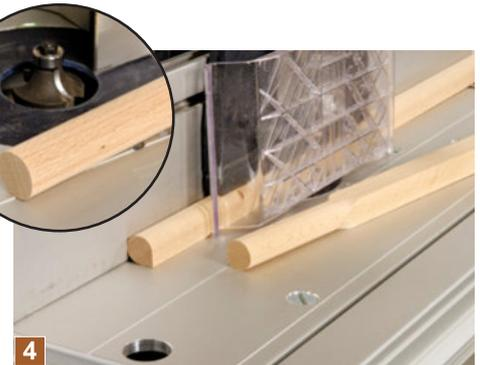
4 Die 19 mm Rundstäbe werden auf dem Frästisch mit einem 9,5 mm Abrundfräser aus 19 mm großen quadratischen Leisten herausgefästä. Dazu jede Kante einmal am Anschlag vorbei führen.
