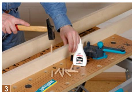
**3** *Anschließend geben Sie Leim in die Dübellöcher und schlagen die 8 x 50 mm Runddübel in die Löcher. Lassen Sie danach das Ganze mindestens eine halbe Stunde trocknen.*
