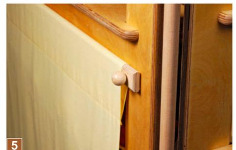
**5** Die Stoffbespannung legt sich um eine 30 x 12 mm große Multiplexleiste, die ebenfalls nur mithilfe eines 6 mm Dübelstabs samt Kugel (wieder lösbar) am Rahmen gehalten wird.
