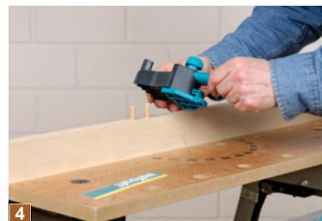
**4** *Erst mit den eingeleimten Dübeln lässt sich der Anschlag der Dübelhilfe einstellen. Dazu wird sie einfach auf die Dübel gesteckt und ihr Anschlag bis zur Rahmenseite geschoben und dort fixiert.*
