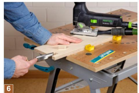
6 Den Rest mit der Stichsäge vorsichtig aussägen. Letzte Einpassarbeiten am besten mit einem scharfen Stechbeitel vornehmen. Der Schlitz sollte möglichst genau zur Rahmenstärke passen.
