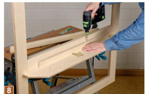
8 Der Boden für die Theke wird mit zwei Holzleisten zusätzlich stabilisiert. Dazu Boden in den Rahmen einlegen, beide Leisten fest gegen Rahmen drücken und am Boden festschrauben.
