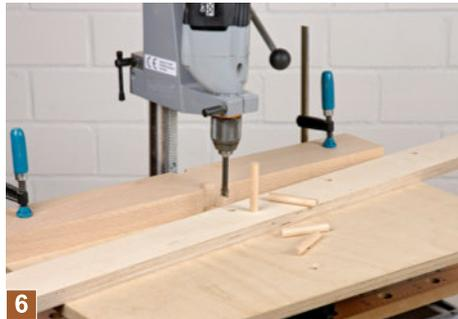
6 Die Regalböden liegen später auf 12 mm Rundstäben. Markieren Sie die Löcher auf den aufrechten Rahmenhölzern und bohren Sie ca. 16 mm tiefe senkrechte Löcher für die Rundstäbe.
