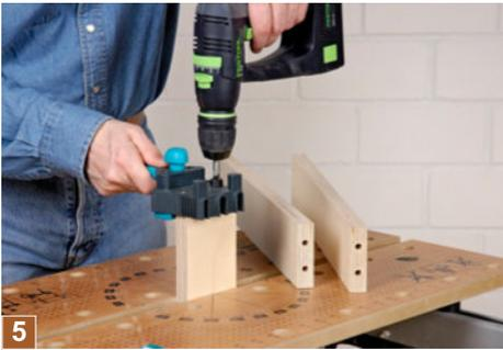
5 So eingestellt können Sie die Dübelhilfe auch zum senkrechten Bohren der Dübellöcher in den Stirnenden der Querrahmen benutzen. Wichtig: alle Löcher vorher genau anzeichnen!
