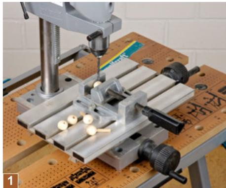
**1** Holzkugel (Ø 20 mm) in den Maschinenschraubstock einspannen und mit einem 6 mm Bohrer ein senkrecht Loch genau in die Mitte der Kugel bohren, anschließend Dübelstab einleimen.
