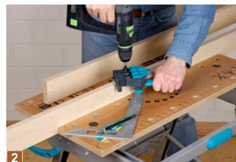
**2** *Zeichnen Sie sich auf alle aufrechten Rahmenhölzer die Positionen der Querrahmen und bohren Sie mit einer Dübelhilfe je zwei 8 mm Dübellöcher für die Querrahmen.*
