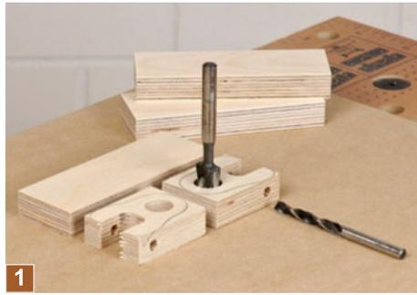
1 Zuerst werden in die 5 cm breiten und 15 cm langen Multiplexstücke 12 mm vom Ende je ein 8 mm Sackloch gebohrt und 45 mm vom Ende ein 20 mm großes Durchgangsloch. Danach ...
