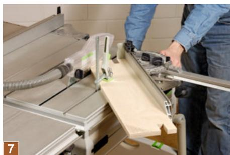
7 Alle vorderen Ecken der Böden müssen auf 45° abgeschrägt werden, sonst stoßen die Ecken gegen die Regalböden der benachbarten Rahmenelemente.
