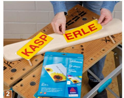
**2** Einfach den Schriftzug auf selbstklebende transparente Folie mithilfe des Computers ausdrucken. Zunächst ein paar Probeausdrucke auf normalem Papier vornehmen.
