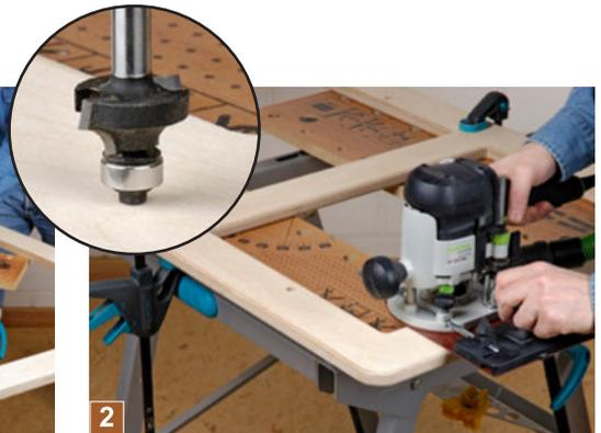
2 Wenn der Leim abgedunsten hat, werden alle „scharfen“ Holzkanten mit einem 5-6 mm Abrundfräser (Viertelstabfräser) mit Kugellager gerundet.
