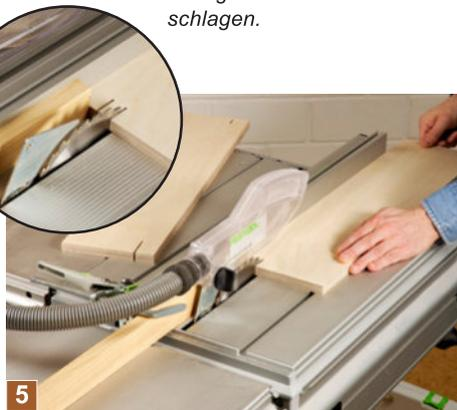
5 Die Böden in der Stärke der Rahmen 41 mm tief ausklinken. Dazu zwei Sägeschnitte mit dem Parallelanschlag machen. Eine Leiste als Anschlag sorgt für die richtige Schnittlänge.
