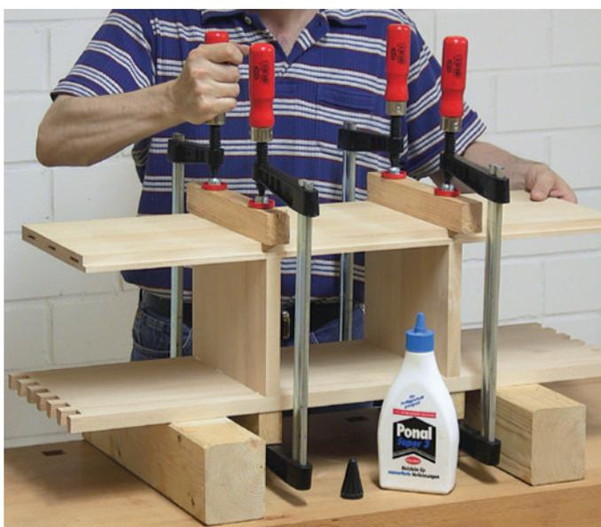
**18** Sind alle Flachdübelschlitzte gefräst, werden zunächst nur Boden, Mittelwände und Zwischenboden miteinander verleimt. Das Ganze sollte dann min. zwei Stunden trocknen, ehe Sie die Zwingen wieder lösen können. Achten Sie beim Ansetzen der Zwingen (Zulagen verwenden!) unbedingt auf einen rechten Winkel der Mittelwände zu den Böden. Benutzen Sie zur Kontrolle am besten einen Qualitätswinkel. Nachdem der Leim abgebunden hat, ist eine Korrektur nicht mehr möglich!
