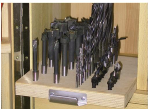
Für die Aufbewahrung von hochwertigen Holzbohrern und Versenker bietet sich ein ca. 25 - 30 mm dickes Brett an, in das einfach den Schaftdurchmessern entsprechend große Löcher gebohrt werden. Damit sich dieses Bohrer-Depot auch leicht herausnehmen lässt, wird es einfach lose zwischen Außenwand und Regal eingeschoben. Eine zusätzliche Griffmuschel an der Vorderkante des Bretts, sorgt für die schnelle und unkomplizierte Entnahme der Bohrer.
