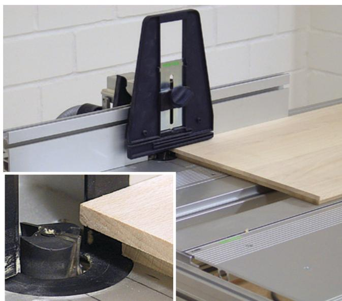
**22** Danach werden mit einem 45 Grad Fasefräser die Kanten der Füllung und die Kanten der Türrahmenbretter leicht angeschrägt. Dabei dürfen die Querrahmenbretter nicht durchgefräst werden, sondern müssen um Brettstärke ein- bzw. ausgesetzt werden. Durch die auswechselbaren Multi Form Plus Fräsköpfe können Sie schnell von Nutfräser auf Fasefräser wechseln.
