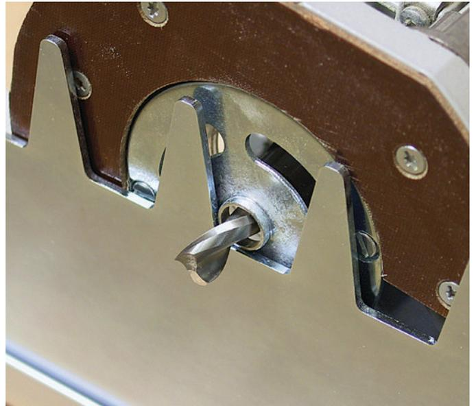
**11** Hier ist gut zu erkennen, dass im Gegensatz zu den Schwalbenschwänzen der Fräser nicht in einem Arbeitsgang das gesamte Material wegfräst, sondern die komplette Schablonaussparung vorsichtig abgefahren wird. Dabei ist es wichtig, den Fräser langsam von links nach rechts zu bewegen und nicht zuviel Material auf einmal wegzufräsen. Es dauert vielleicht etwas länger, dafür bleibt der Fräser aber länger scharf und das Fräsergebnis ist wesentlich sauberer.
