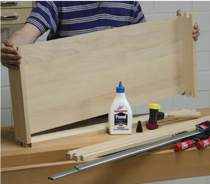
**24** Stecken Sie vor dem Verleimen erst einmal die beiden kurzen Querrahmenbretter auf die Füllung. Danach geben Sie etwas Leim zwischen die Schwalbenschwänze bzw. Zinken. Nehmen Sie die gesamte Konstruktion und stecken Sie sie auf das Seitenbrett. Zum Schluß das andere Seitenbrett auflegen und alles mit Hammer und Zulagen fest zusammenfügen. Bis der Leim abgebunden hat, sollten zwei Zwingen die Verbindungen zusammenhalten.
