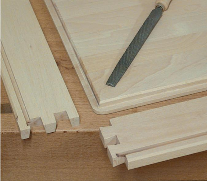
**23** Bevor Sie nun die Türen verleimen können, müssen die Ecken der Füllungen mit einer Raspel bzw. Feile abgerundet werden. Diese Rundung ist notwendig, weil die Nut in den Türrahmenbrettern nicht durchgefräst werden durfte. Sie entspricht genau dem Radius des Scheibennuträasers.
