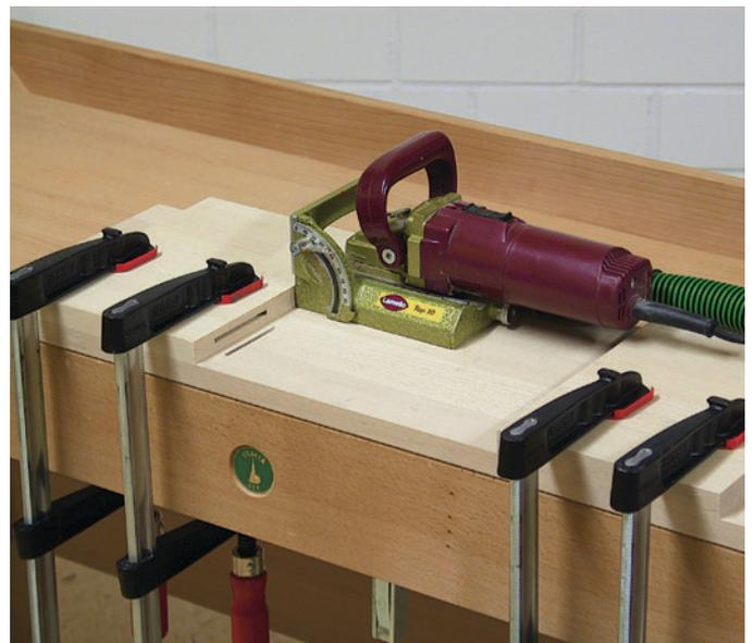
**16** Um die Seitenwände des Korpus mit den Flachdübelschlitzten zu versehen, sollten Sie den gesamten Korpus – ohne Leim!!! – einmal zusammenstecken. Jetzt können Sie eine Mittelwand in der unteren Ecke mit Zwingen befestigen und erhalten so den richtigen, exakten Abstand für die Flachdübelschlitzte bzw. die Fräse. Beim Einsatz von Flachdübeln, sind im Gegensatz zu den Runddübeln, so gut wie keine langwierigen Markierungen notwendig.
