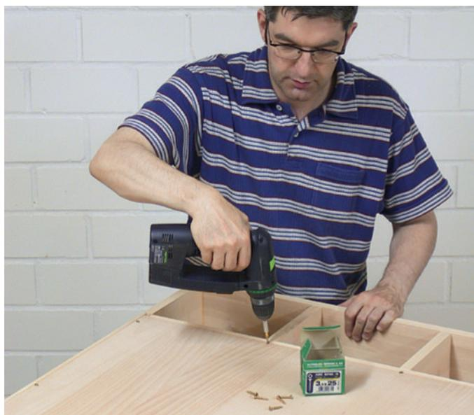
**39** Die Montage der Schrankaufhänger erfolgt, nach der Befestigung der Rückwand, einfach mit zwei Schrauben. Aufgrund der Position der Aufhänger direkt unterhalb des Deckels, reicht diese Befestigung völlig aus, da Deckel und Seitenwände durch formschlüssige Schwalbenschwanzzinken unlösbar zusammengehalten werden.
