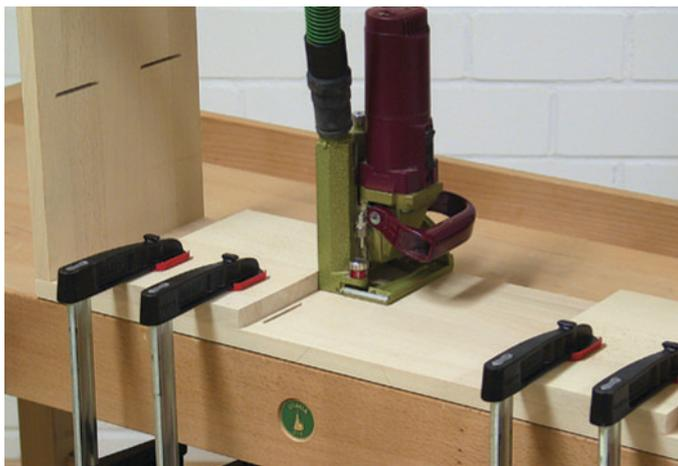
**17** Genau wie in Bild 14, werden auch beim Unterboden des Schrankes die beiden Mittelwände mit Zwingen befestigt und als Anlage für die Flachdübelfräse benutzt. Auch hier ist es sehr wichtig, dass die Einteilung des Bodens in drei gleiche Abschnitte genau mit dem Zwischenboden aus Bild 14 übereinstimmt, damit die Mittelwände später nicht „schief“ stehen.
