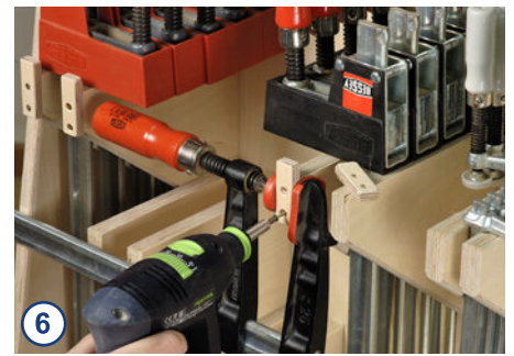
6 Ein kleines 9 mm dickes Multiplexklötzchen verhindert, dass die Zwingen vorne von der Konsole runterfallen können.
