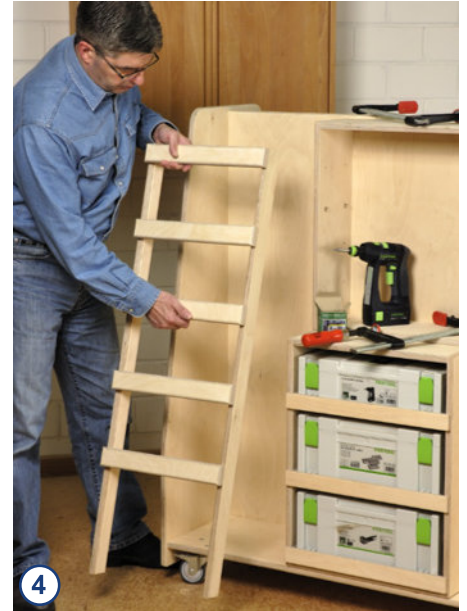
4 Zum Schluss befestigen Sie je eine Zwingenleiter mit ein paar Spanplattenschrauben links und rechts neben dem Systainerturm.
