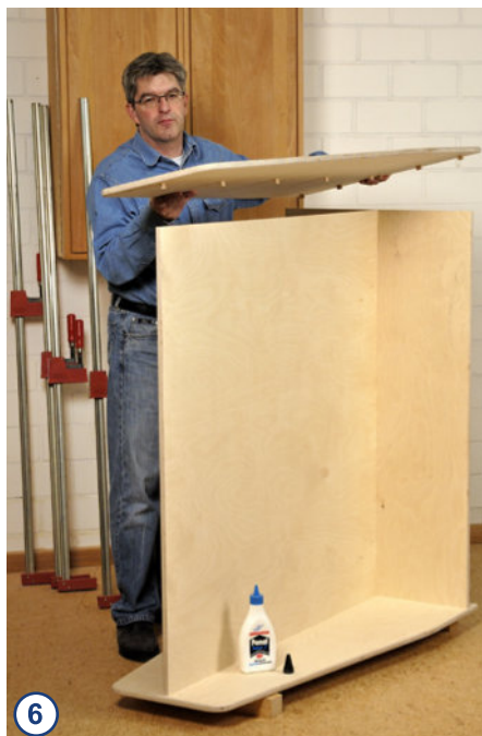
6 Schlagen Sie zuerst in die Stirnseiten alle Dominos mit Leim ein. Legen Sie anschließend zwei Holzbalken flach auf den Fußboden und eine Stirnseite darauf. Geben Sie Leim in die Schlitz von Mittelwand und Boden und stecken Sie beides auf die Stirnwand. Zum Schluss legen Sie die zweite Stirnwand auf. Da die Werkstücke recht groß sind, sollten Sie unbedingt eine weitere Person um Hilfe bitten!
