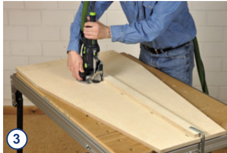
3 Auch für die Mittelwand fräsen Sie mit der Domino-Fräse fünf Dübel (5 x 30) ein. Dazu benutzen Sie wie zuvor eine Leiste als Anschlag.
