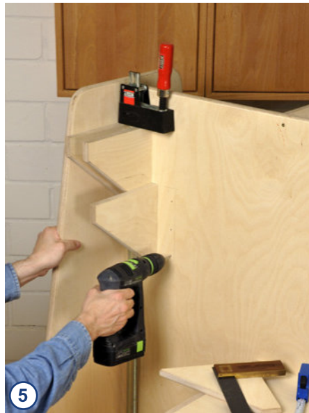
5 Auf der gegenüberliegenden Seite befestigen Sie Winkelkonsolen zur Aufnahme der Korpuszwingen. Drei 4 x 60 mm Spanplattenschrauben je Konsole.
