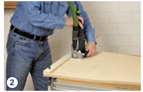
2 Spannen Sie eine 5 cm breite Leiste als Anschlag für die Domino-Fräse auf die Stirnwand und fräsen Sie fünf 5 x 30er Dominos für den Boden ein.
