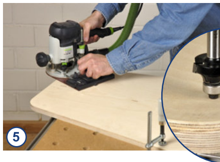
5 Vor dem Verleimen werden alle Kanten mit einem Abrundfräser mit Kugellager (kl. Foto) entschärft. Am besten lässt sich die Fräse dabei mit der als Zubehör erhältlichen Tischverbreiterung führen. Sie verhindert, dass die Fräse zur Seite wegkippt - ein sehr nützliches Zubehör!
