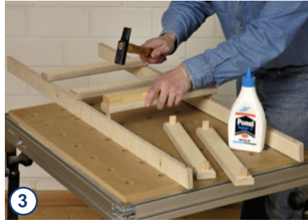
3 Leimen Sie die Dominos zuerst in die Querleisten. Anschließend geben Sie Leim in die Schlitze der Seitenholme und stecken die Leisten ein.
