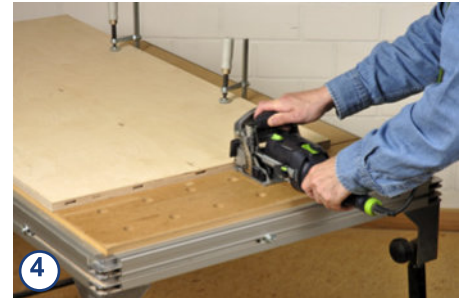
4 Den Boden (und analog dazu die Mittelwand) legen Sie flach auf den Werkstisch und fräsen die entsprechenden Dominoschlitz in die Kante.
