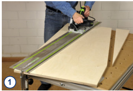
1 Die Schrägschnitte für die Stirnwände erledigen Sie am besten mit einer Handkreissäge, die auf einer Sägescheibe geführt wird.
