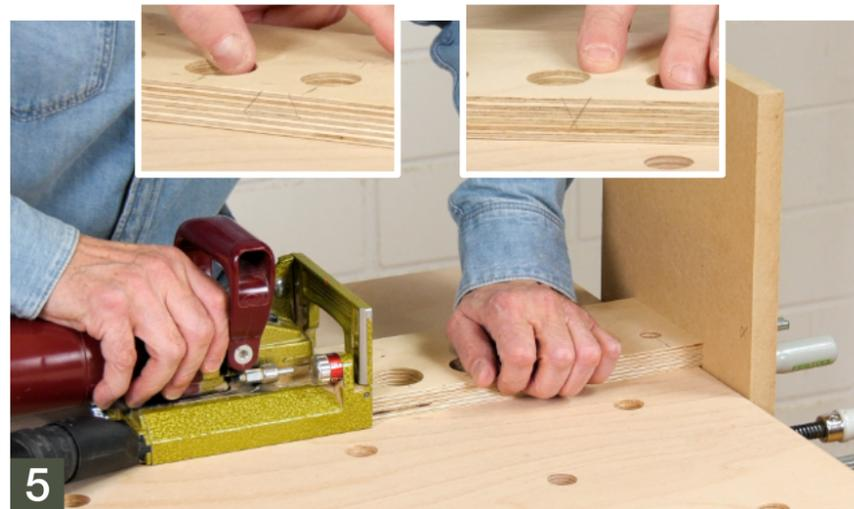
**5** Spannt euch eine Restplatte (z. B. aus MDF) mit zwei Zwingen hochkant an die Werkbankzarge. Danach legt ihr die Lochplatten mit der Außenfläche (also der Dreieckspitze und dem Dreieckgrund) auf die Werkbank und fräht in die Stirnkanten je einen Flachdübel ein.
