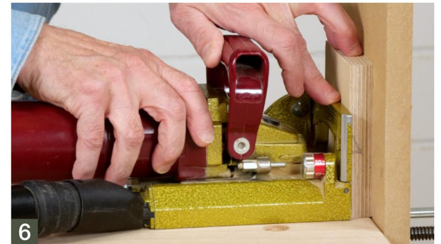
**6** Die beiden Seitenteile legt ihr anschließend hochkant gegen die MDF-Platte (die Dreieckspitze zeigt immer zur Platte) und fräht so den passenden Gegenschlitz für den Flachdübel ein. Mit so einer simplen Stütz- bzw. Winkelplatte lassen sich Außenecken extrem einfach und absolut präzise mit Flachdübeln verbinden.
