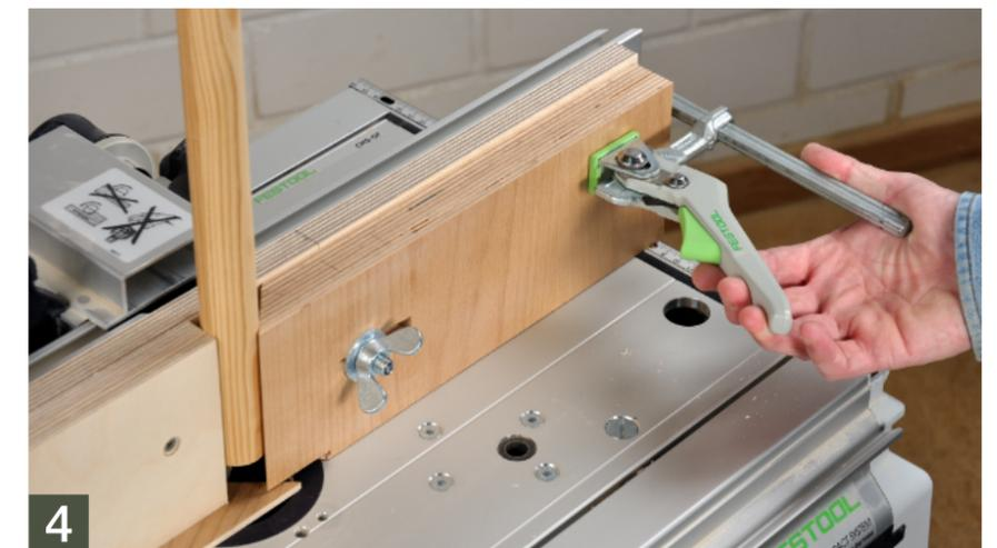
**4** Damit die gesamte Vorrichtung und auch das Andruckbrett sicher und fest am Fräsanschlag und Rundstab anliegen, spannt ihr jetzt auch noch die rechte Seite der Vorrichtung mit einer Hebelzwinge fest.
