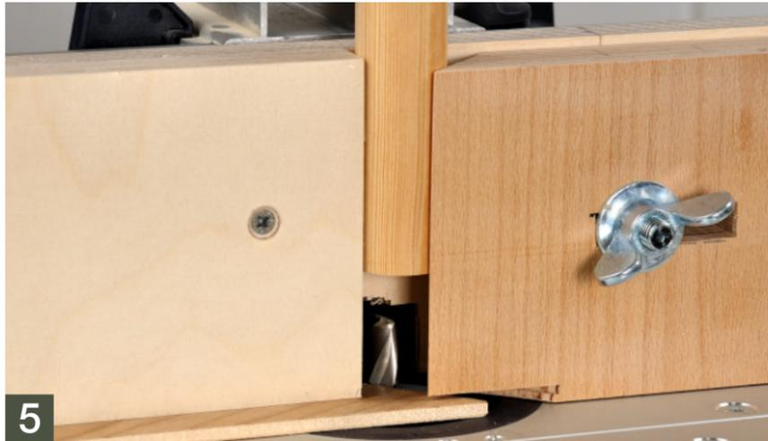
5 Soweit ist alles eingestellt und ihr könnt jetzt den Rundstab bei laufendem Fräser von oben in die Vorrichtung stecken. Sobald er den Fräser berührt, dreht ihr ihn im Uhrzeigersinn langsam und mit leichtem Druck nach unten in den Fräser hinein, ...
