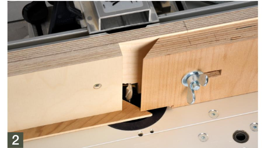
... ungefähr in der Mitte der Aussparung der Grundplatte (Pos. 1) befinden. Durch Verschieben des Anschlags samt Vorrichtung (vor und zurück), könnt ihr auch hier wieder den gewünschten Zapfendurchmesser genau einstellen.
