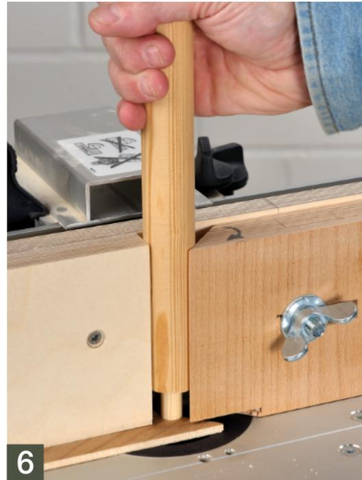
6 ... bis er auf dem Anschlagsperrholz aufliegt. Danach die Leiste wieder im Uhrzeigersinn drehend aus der Vorrichtung herausziehen. Wenn der Rundzapfen zu dick ist, müsst ihr nur den Fräsan-schlag ein klein wenig nach hinten verschieben und den Zapfen noch einmal bearbeiten.
