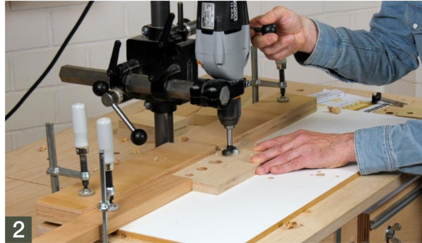
**2** Auf einem Bohrstand oder einer Säulenbohrmaschine bohrt ihr jetzt nacheinander mit einem Forstnerbohrer die 15, 20, 25 und 35 mm Löcher in die Lochplatten. Damit alle Bohrungen bei beiden Platten auch exakt deckungsgleich sind, unbedingt mit Anschlagleisten arbeiten.
