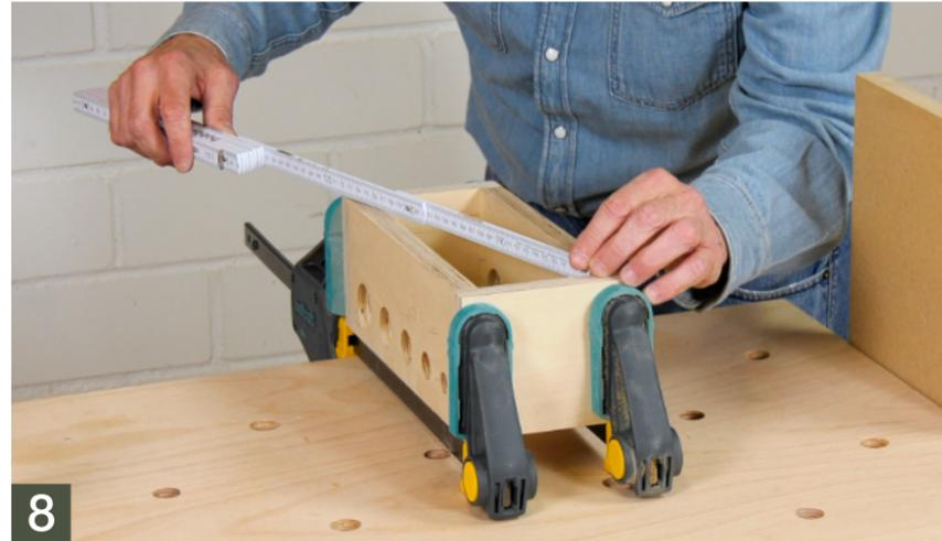
Wichtig ist aber, dass ihr nach dem Ansetzen der Zwingen nochmal den rechten Winkel des Kastens durch die Diagonalmessung überprüft. Sind die Diagonalen nicht exakt gleich lang, könnt ihr das mit leicht schräg angesetzten Zwingen wieder ausgleichen.
