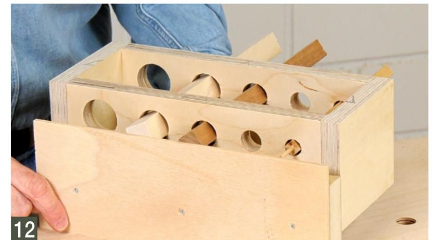
Und so sollte die Vorrichtung am Ende aussehen. Gut zu erkennen ist hier auch, dass die Sperrholzkante in etwa mittig zu den Leistenenden bzw. späteren Zapfen verläuft. Das vereinfacht auch das Ausrichten der Vorrichtung am Fräser.
