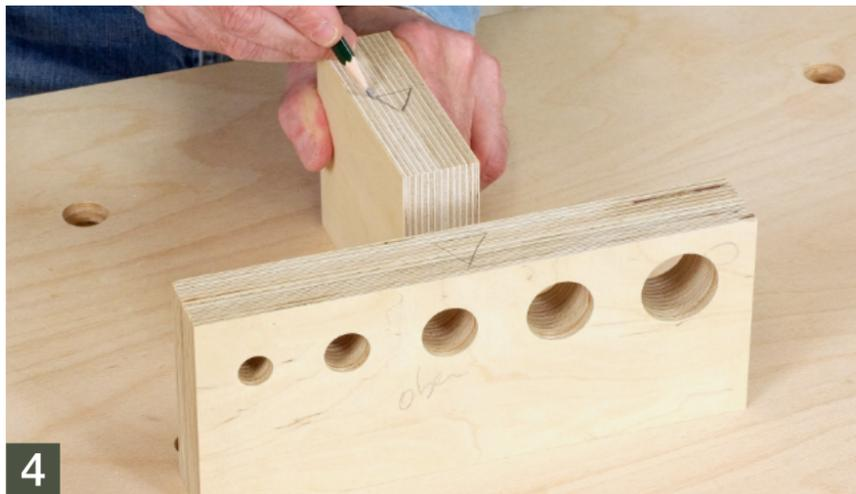
**4** Die beiden Lochplatten und die beiden Seitenteile markiert ihr als nächstes mit einem Schreinerdreieck. So sind alle Bauteile in den Bearbeitungspositionen festgelegt und ihr könnt sie nicht mehr verwechseln.
