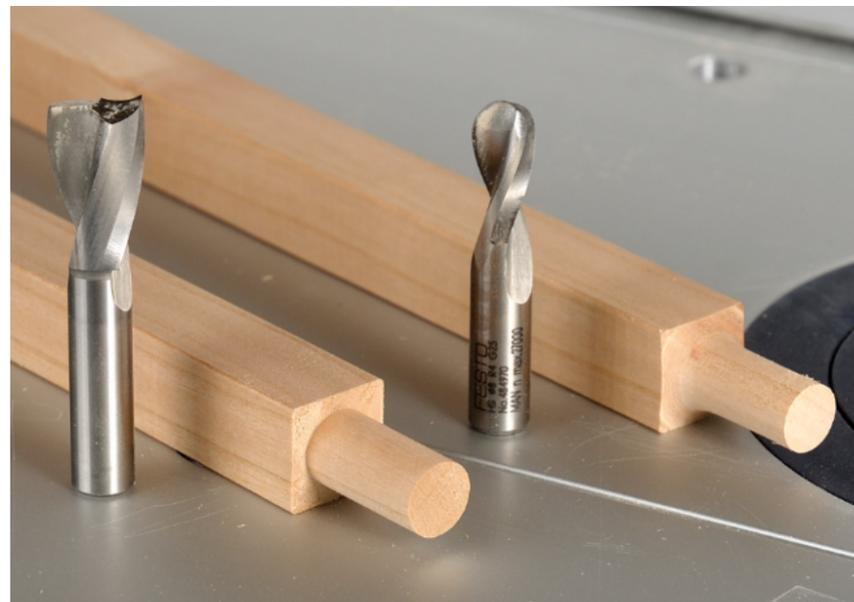
Spiralnutfräser eignen sich am besten zum Herausfräsen der Rundzapfen. Dabei kann die „Brüstung“ des Zapfens entweder scharfkantig (li.) oder hohlkehlförmig (re.) angefräst werden.
