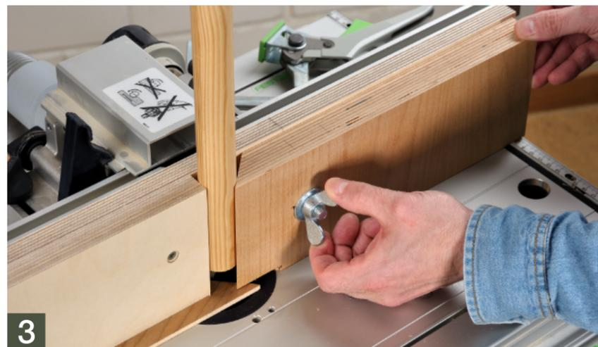
**3** Dann steckt ihr den Rundstab ein und schiebt das Andruckbrett (Pos. 3) mit seiner 45° schrägen Kante dicht an den Rundstab heran. Anschließend fixiert ihr die Position des Andruckbretts mit der Flügelmutter.
