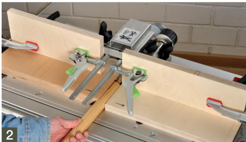
2 Danach spannt ihr die beiden Vorrichtungswinkel so mit Hebelzwingen am Fräsanschlag fest, dass der Rundstab spielfrei eingeklemmt ist, sich aber noch drehen lässt. Jetzt die Maschine einschalten und den Rundstab in Pfeilrichtung - also im Uhrzeigersinn - drehen und zum Schluss drehend wieder aus der Vorrichtung rausziehen.
